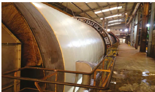
Figure 2 : Schéma d'un diffuseur horizontal (Decloux 2002) et photographie d'un diffuseur RT (SNFS 2014)
