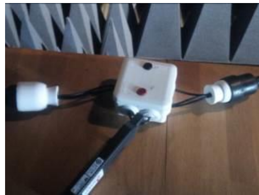
Figure 3-2 : compteur Linky et système de mesure du courant électrique
