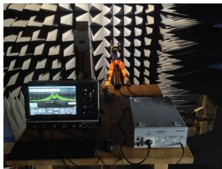
Figure 3-6: caractérisation des niveaux de sortie en tension des compteurs Linky prêtés par Enedis (norme EN 50065-1)
