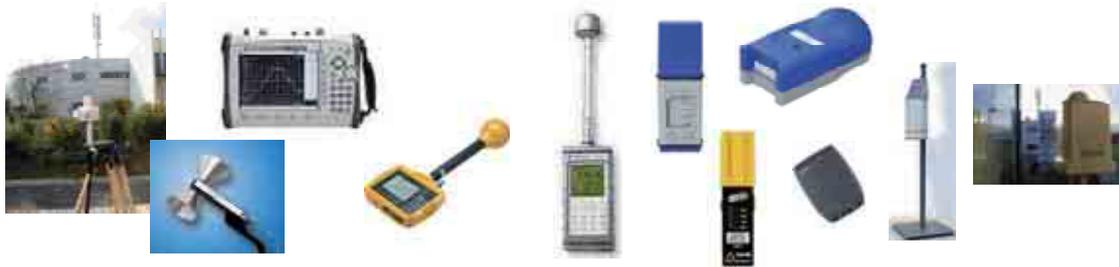
Mesures spectrales - sonde large bande - dosimètres portables – stations de mesure fixes
