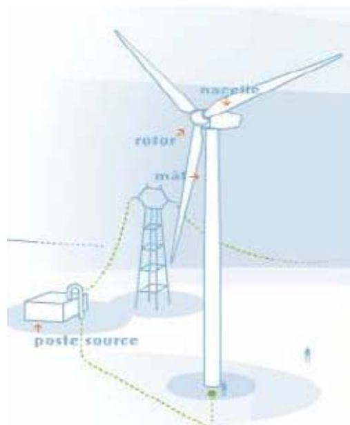
Figure 1 : Eléments d'une éolienne
