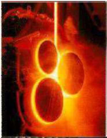
Figure 7: procédé rotatif employé pour la production de laines de roche (IARC, 2002 ; FILMM, 2007)
